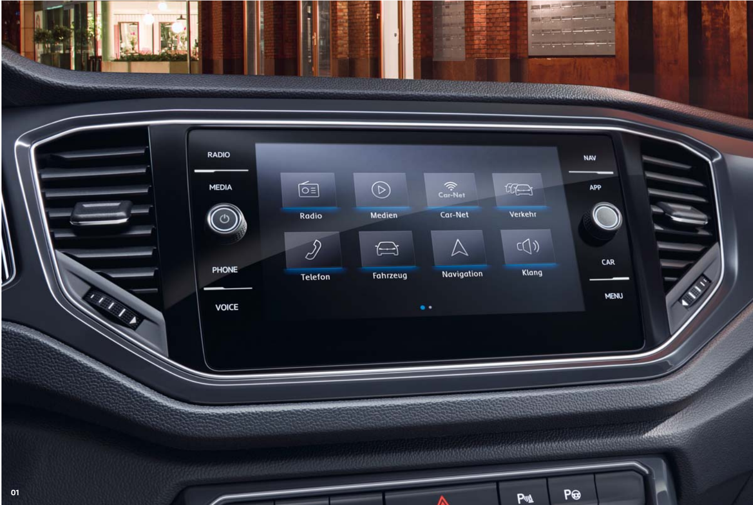
01 El sistema de navegación opcional “Discover Media” está equipado con una pantalla táctil en color de 20,3 cm (8 pulgadas). Disfruta, además, de seis altavoces, recepción de radio FM, lector de CD compatible con los formatos MP3, AAC y WMA, dos ranuras para tarjeta SD, un puerto USB e interfaz para teléfono por Bluetooth. O
