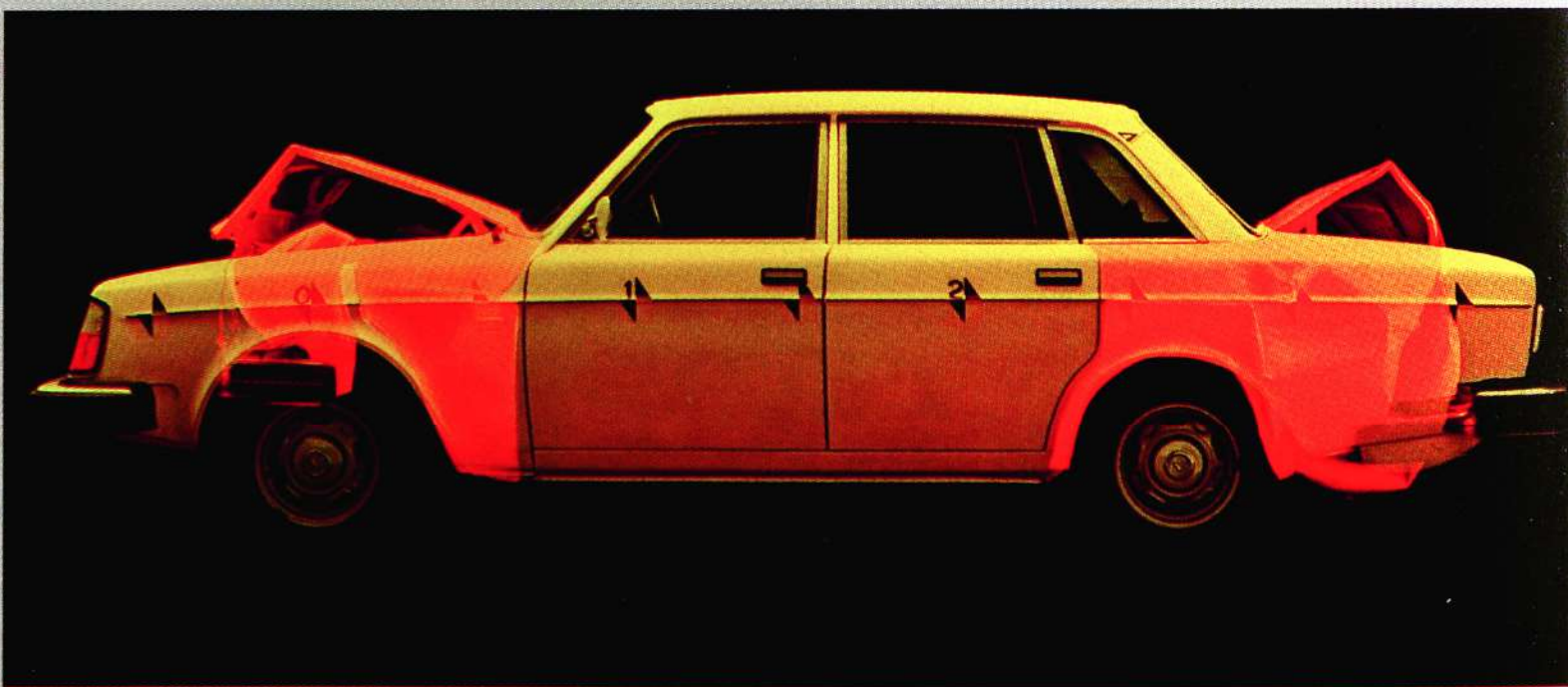
La carrocería de un Volvo es al mismo tiempo dura y blanda. Las partes blandas son la frontal y posterior que absorben la energía liberada en un choque. La parte dura es la estable coraza protectora que rodea el habitáculo.
