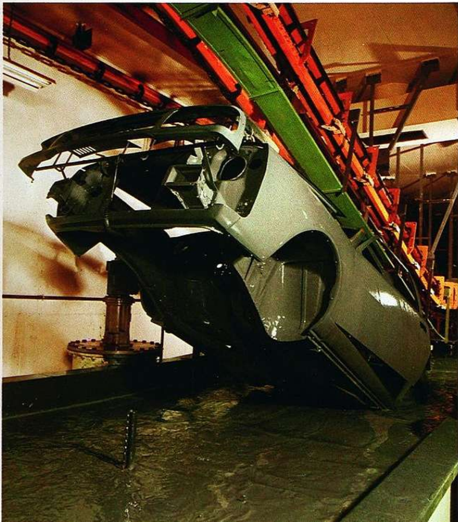
Ya por tradición, el tratamiento anticorrosivo en Volvo es muy extenso. Toda la parte inferior del coche se cubre con alquitrán flexible y los bordes se refuerzan con una robusta capa de PVC.
