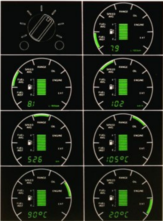
El Centro Electrónico de Información le proporciona al instante datos actualizados o le avisa de cualquier fallo en las funciones principales del coche. Girando el mando puede seleccionar cualquiera de los 7 canales para obtener información instantánea sobre consumo medio o momentáneo, velocidad media, autonomía de combustible, temperatura del aceite o del agua y temperatura exterior (particularmente útil para detectar hielo en la calzada).
