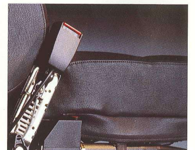
El tensor del cinturón hace que éste resulte aún más efectivo al eliminar cualquier holgura en el cinturón antes de que el cuerpo del ocupante sea empujado hacia delante en una colisión.
