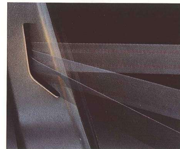
La altura de la cinta en los cinturones de seguridad delanteros se ajusta automáticamente al cuerpo del ocupante. Esto no sólo proporciona mayor confort, sino que además hace que el cinturón cumpla su cometido de modo más eficaz en caso de accidente.
