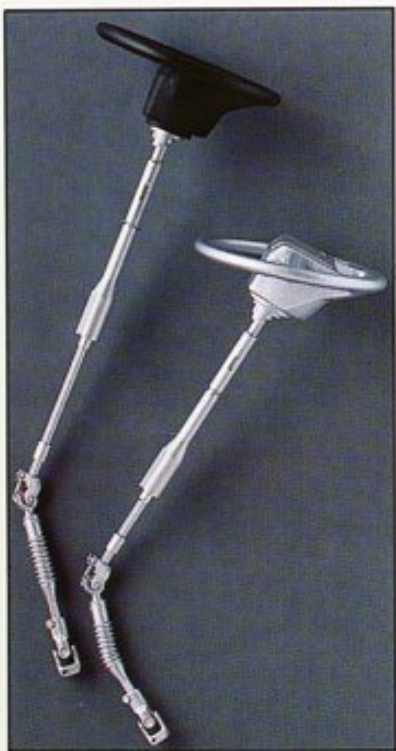
El volante de un Volvo 740 cede plegándose en una colisión.
