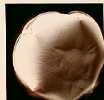
El Airbag de 65 litros del conductor está situado en el volante. Para el asiento delantero del acompañante hay un Airbag opcional de 135 litros. En caso de colisión frontal suficientemente grave, se inflan en una fracción de segundo.
