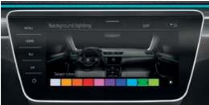
LED-tunnelmavalaistus jossa 10 värvaihtoehtoa
