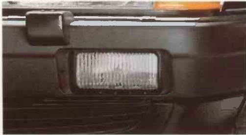
Phares anti-brouillard à iode pour mieux voir et être mieux vu.
