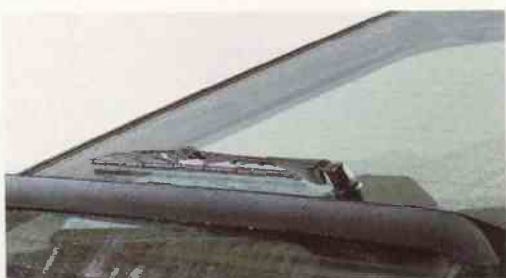
Pour mieux affronter les intempéries: essuie-lave-glace arrière à balayage intermittent (Avant).
