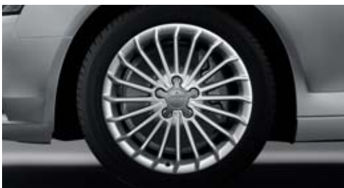
Jantes hiver en aluminium coulé style 20 branches dynamiques 7 J x 17 avec pneus 225/50 R 17, compatibles chaînes-neige, vitesse maximale 210 km/h (en option avec pneus avec propriétés de roue de secours)
