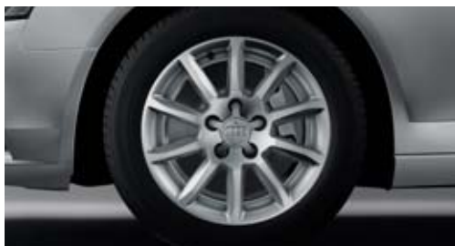
Jantes en aluminium forgé style 10 branches 7,5 J x 16 avec pneus 225/55 R 16, en option pour 2.0 TDI (100 kW) A4 berline 112 g Co 2 /km ; A4 Avant 116 g Co 2 /km : 7 J x 16 avec pneus 205/60 R 16
