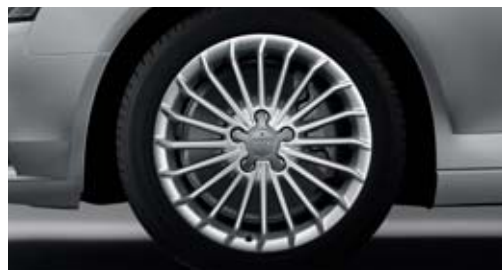
Jantes en aluminium coulé style 20 branches dynamiques 7,5 J x 17 avec pneus 225/50 R 17
