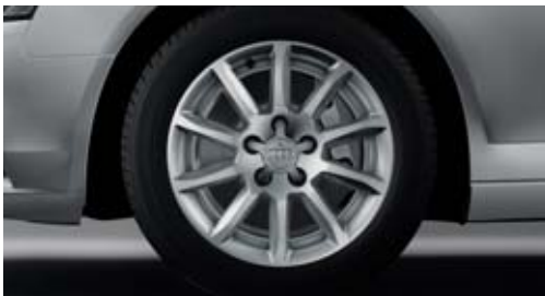
Jantes hiver en aluminium coulé style 10 branches 7 J x 16 avec pneus 225/55 R 16, compatibles chaînes-neige, vitesse maximale 210 km/h
