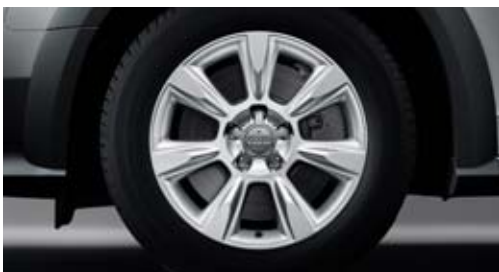
Jantes hiver en aluminium coulé style 7 branches en V 7,5 J x 17 avec pneus 225/55 R 17, compatibles chaînes-neige, vitesse maximale 210 km/h
