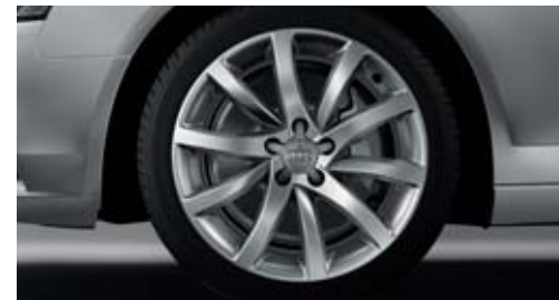
Jantes en aluminium coulé style 10 branches dynamiques 8 J x 18 avec pneus 245/40 R 18
