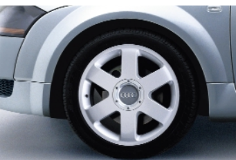
De série sur 1.8 T quattro, en option sur 1.8 T : Jantes en aluminium, style 6 branches, 7 J x 17, pneus 225/45 R 17 V, roue de secours à encombrement réduit.
