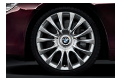
Jantes en alliage léger 19" (48 cm) style 349 L. AV : 8,5 J x 19, 245/40 R 19 ; AR : 9 J x 19, 275/35 R 19.
