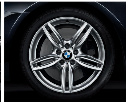
Jantes en alliage léger 19" (48 cm) style 351 M à rayons doubles avec monte pneumatique mixte ; dimensions : 8,5 J x 19 à l'avant, pneumatiques 245/40 R 19 ; 9 J x 19 à l'arrière, pneumatiques 275/35 R 19.
