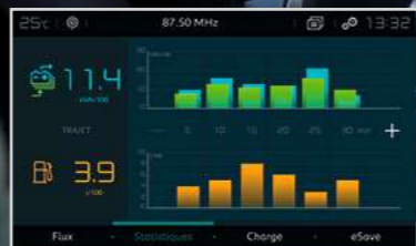
Statistiques : permet de connaître sa consommation électrique et thermique pour optimiser sa conduite.
