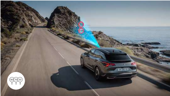
RECONNAISSANCE ÉTENDUE DES PANNEAUX ET RECOMMANDATION DE VITESSE* Ce système informe sur la limitation à respecter. Quand un panneau de limitation de vitesse est détecté par la caméra, le conducteur peut accepter la recommandation de vitesse et en faire sa vitesse de régulation ou de limitation. Sont également détectés les panneaux « Stop », « Sens interdit » et « Interdiction de dépasser ».
