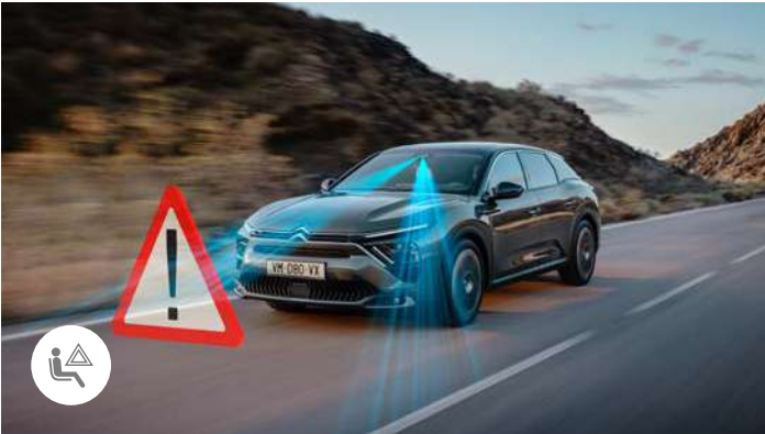
ALERTE ATTENTION CONDUCTEUR Ce système évalue l'état de vigilance du conducteur en identifiant les écarts de trajectoire par rapport aux marquages au sol. Cette fonction est particulièrement adaptée sur les voies rapides, à plus de 65 km/h.
