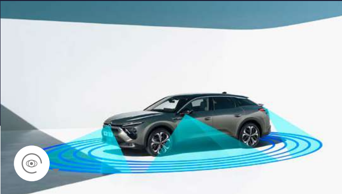
VISION 360* Activée automatiquement au passage de la marche arrière ou manuellement, cette assistance vidéo pour toutes les manœuvres à basse vitesse affiche sur la tablette tactile une vision du dessus de C5 X et de son environnement à 360° grâce à 4 caméras HD.
