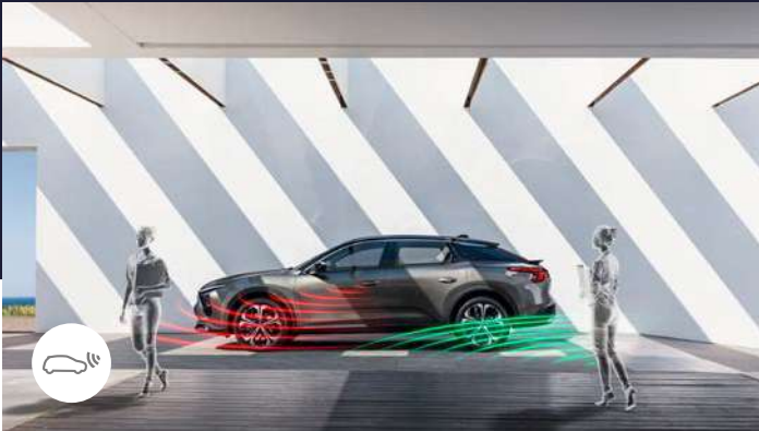
ADML PROXIMITY* L'accès et démarrage mains libres Proximity verrouille et déverrouille automatiquement les portes de C5 X lorsque le conducteur s'en approche ou s'en éloigne. Il suffit pour cela qu'il ait la clé sur lui.
