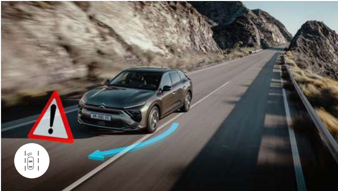
ALERTE ACTIVE DE FRANCHISSEMENT INVOLONTAIRE DE LIGNE Ce système fonctionne à l'aide d'une caméra qui reconnaît les lignes continues et discontinues. En cas de rapprochement de la ligne, sans activation des clignotants, la direction contre-braque alors progressivement pour maintenir le véhicule dans sa voie initiale. Cette technologie permet de lutter contre l'hypovigilance du conducteur.
