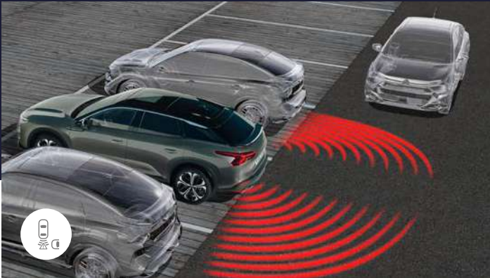
ALERTE DE TRAFIC ARRIÈRE* Ce dispositif détecte tout danger – piéton, moto, vélo ou véhicule – à proximité lors des manœuvres en marche arrière.
