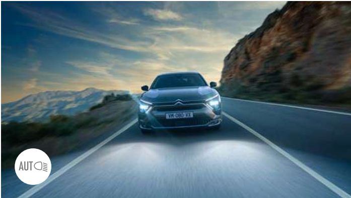
COMMUTATION AUTOMATIQUE DES FEUX DE ROUTE* Cette fonction prend en charge la permutation des feux de route et des feux de croisement, en fonction du trafic, quand des voitures arrivant en face ou en dépassement sont détectées. Ce système apporte un éclairage optimal en conduite de nuit.
