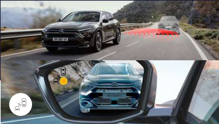
SYSTÈME DE SURVEILLANCE D'ANGLE MORT LONGUE DISTANCE* Très utile sur les voies rapides ou les autoroutes, ce système de surveillance indique au conducteur la présence d'un véhicule dans les angles morts, jusqu'à 70 m en arrière de C5 X, grâce à une diode orange placée dans l'angle des rétroviseurs extérieurs.
