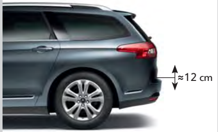
UNE COMMANDE PLACÉE SUR LE CÔTÉ DROIT DU COFFRE PEUT ÊTRE ACTIONNÉE, MOTEUR COUPÉ, POUR ABAISSER OU RELEVER LE SEUIL D'ENTRÉE DE COFFRE D'UNE AMPLITUDE DE 12 CM, SELON VERSION.
