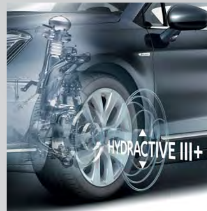
DES CAPTEURS ANALYSENT EN CONTINU LE STYLE DE CONDUITE ET LE PROFIL DE LA ROUTE.
