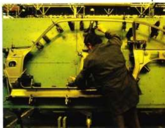
Contrôle de gabarit d'un élément de carrosserie.
