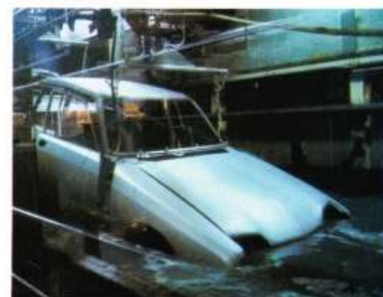
Passage d'une caisse au bain d'électrophorèse.
