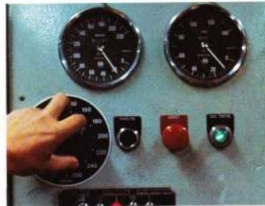
Contrôle de fonctionnement d'un maître-cylindre de frein.
