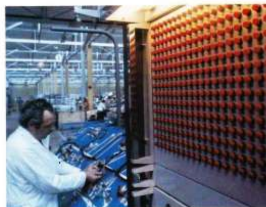
Contrôle de fonctionnement d'un faisceau électrique.
