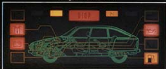
Cadran de contrôle du tableau de bord.
