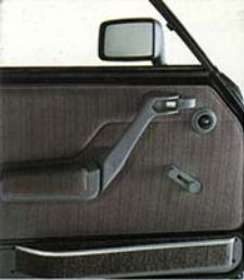
Rétroviseur extérieur réglable de l'intérieur et vide-poches sur porte avant.
