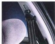
Les ceintures de sécurité avant avec pré-tensionneur et bloqueur de sangle peuvent être réglées en hauteur.
