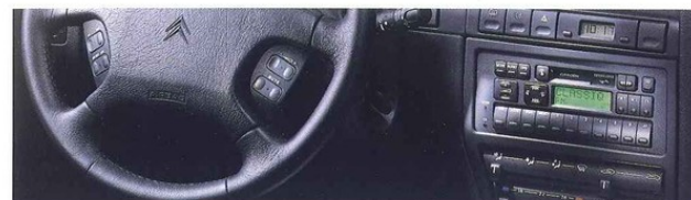
Grâce aux commandes situées de part et d'autre du volant, le conducteur n'a plus à quitter la route des yeux pour piloter son Système Audio.
