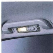
Spot de lecture fixé sous la poignée de maintien, côté passager avant.
