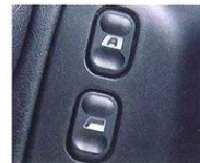
Les lave-glaces AV électriques comprennent une commande séquentielle côté conducteur : une simple impulsion suffit pour la baisser et la lever.
