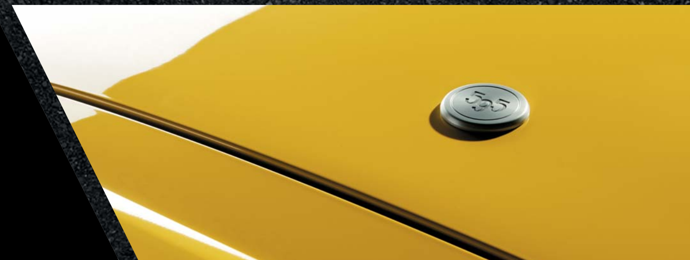
Antenne radio cachée avec bouchon 595 en aluminium gravé sur le toit (berline uniquement).
