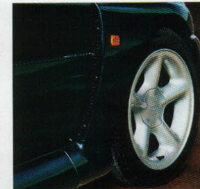
Grilles d'évacuation d'air sur ailes avant et jantes alliage
