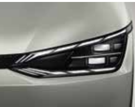
Projecteurs avant Full LED matriciels avec gestion intelligente des feux de route (de série dès la finition GT-line)
