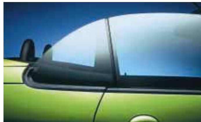
● Les vitres avant sans encadrement et celles de custode escamotables lui confèrent une ligne exceptionnelle en configuration cabriolet.
