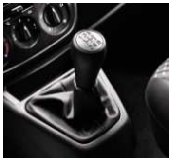
Boîte de vitesses mécanique 5 rapports
