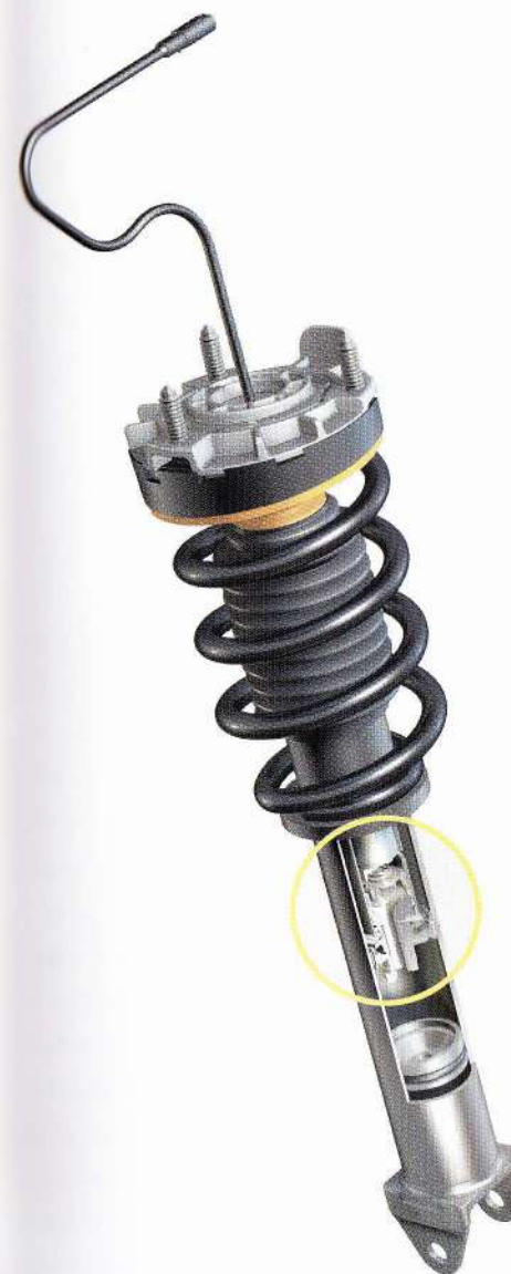
Phase de détente – Piston moteur et by-pass = réglage sportif confortable
