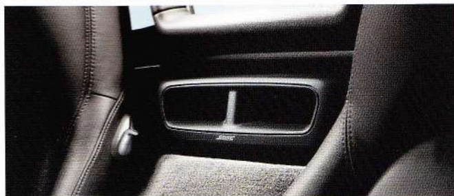
Subwoofer actif avec respectivement 2 HP 13,0 cm pour les graves et 2 HP 6,4 cm médium-aiguës
