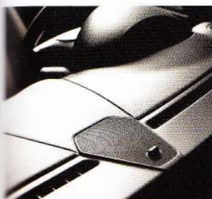
Enceinte Néo-dyme 7,0 cm pour les fréquences moyennes (Haut-parleur central)
