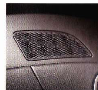
Enceinte Néodyme 2,5 cm pour les fréquences aiguës
