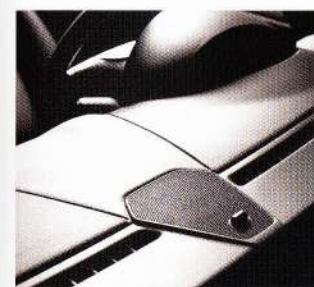
Enceinte 7,0 cm pour les fréquences moyennes (HP central)
