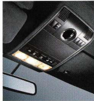
Commande ciel de toit
