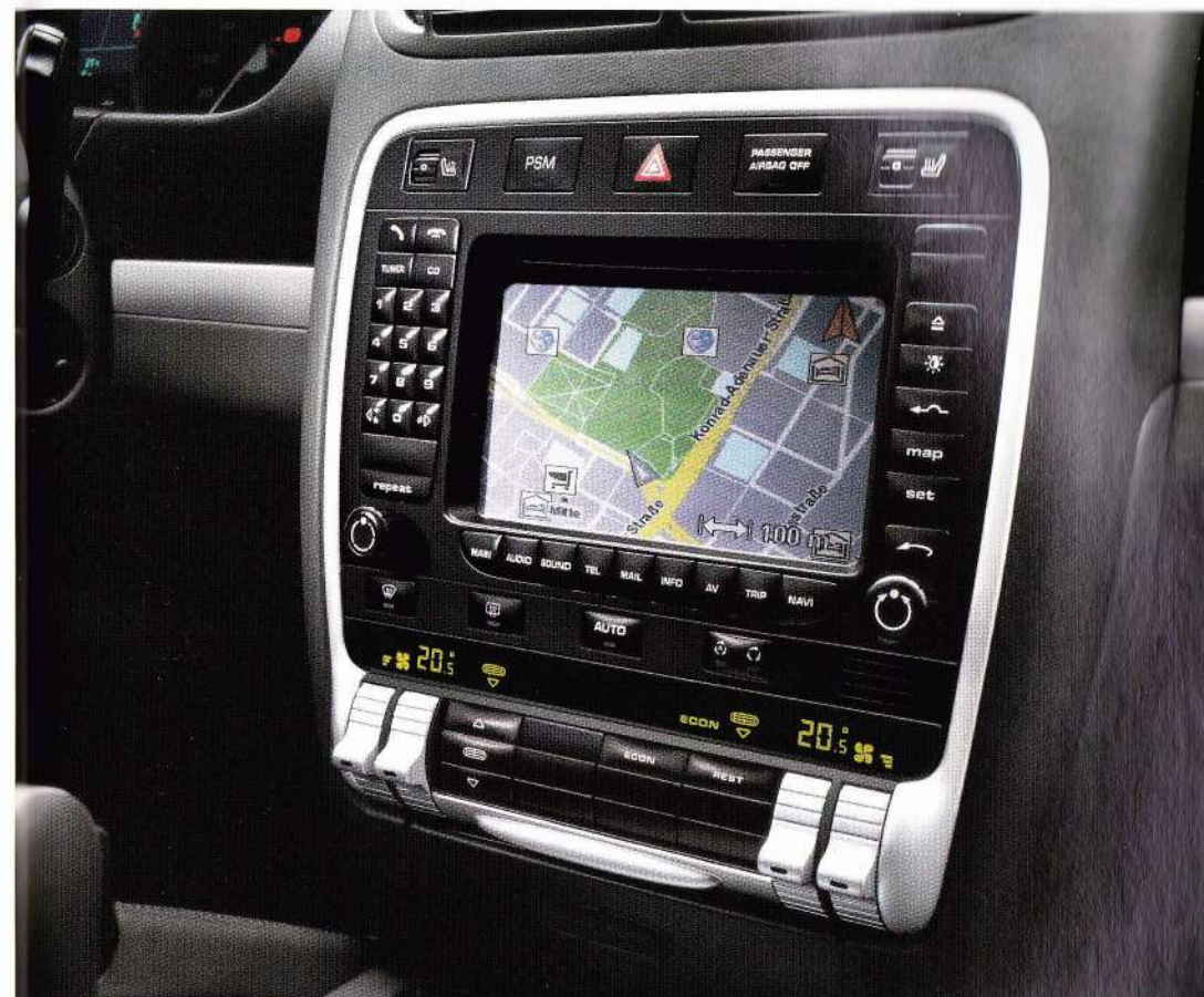
PCM, commande de climatisation, volet ouvert
