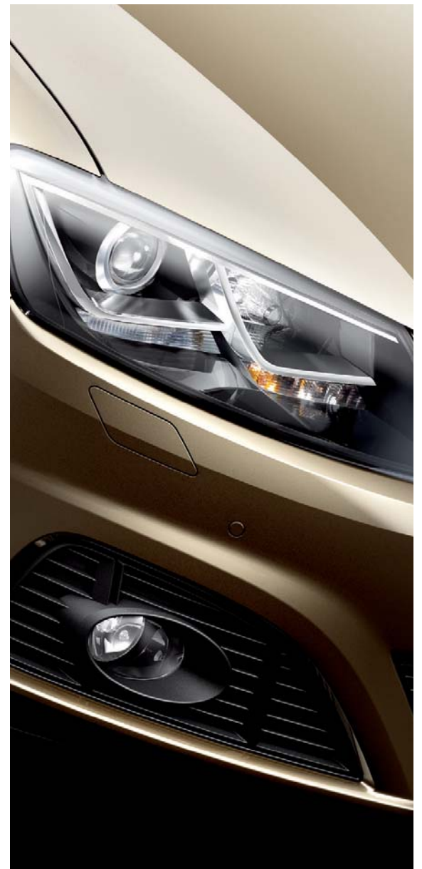
Phares avant Bi-Xénon auto-directionnels (suivent l'inclinaison du volant pour éclairer l'intérieur des virages).
