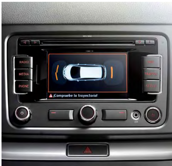
L'Optical Park System, lié aux radars avant et arrière, schématise sur l'écran de l'autoradio ou du GPS, la distance aux obstacles lors des manoeuvres.
