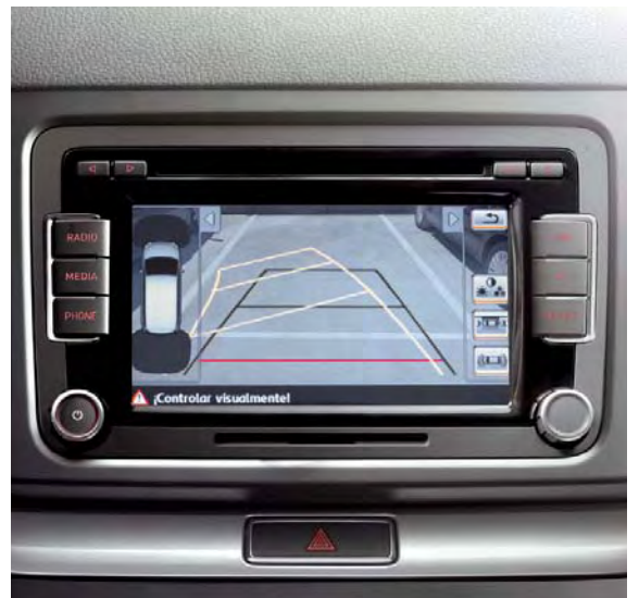
La caméra de recul permet une vision exacte de la situation à l'arrière de son véhicule. Elle sécurise les manoeuvres pour les piétons et préserve votre carrosserie.
