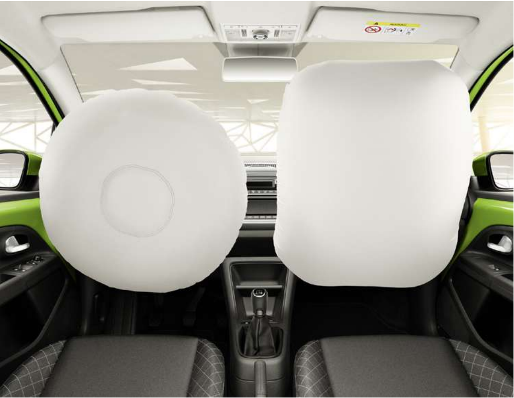
AIRBAGS FRONTAUX Les airbags conducteur et passager sont activés en conjonction des prétensionneurs des ceintures de sécurité avant. L'ensemble contribue fortement à votre sécurité en cas de besoin.
