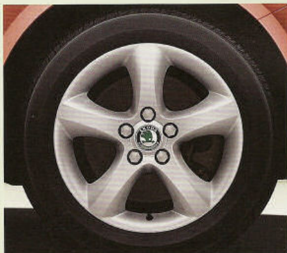
Jantes en alliage léger ANTARES 6.0J x 15" pour pneus 195/55 R15
