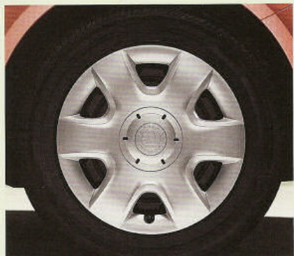
Jantes en acier 6.0J x 15" pour pneus 195/55 R15 avec enjoliveurs HERMES
