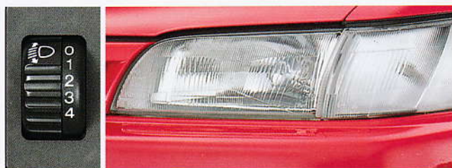
Blocs optiques avant à ampoules halogènes avec réglage électrique du site des phares
