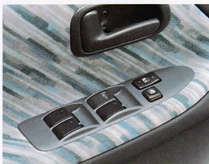
Console regroupant les commandes des quatre vitres électriques, la condamnation centralisée des portes et des vitres passagers
