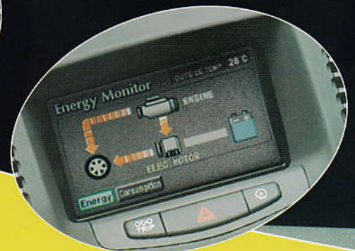
Dans ce cas, l'entraînement des roues se fait par l'intermédiaire du moteur thermique qui fournit également l'énergie au moteur électrique.
