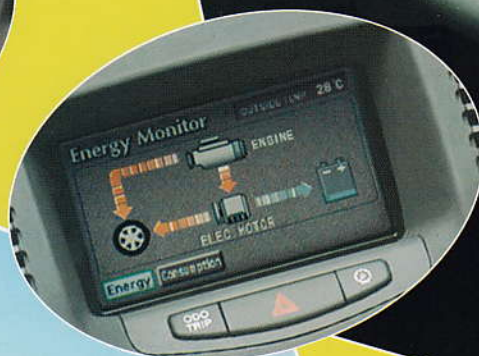
L'écran tactile affiche le statut énergétique : le moteur thermique actionne les roues motrices, fournit l'énergie au moteur électrique et recharge les batteries...
