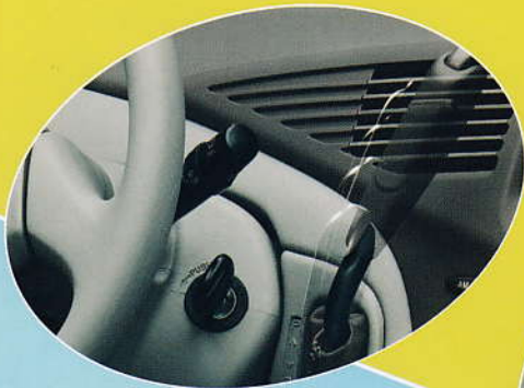
Commande de transmission au volant. Elle libère de la place entre les sièges avant.
