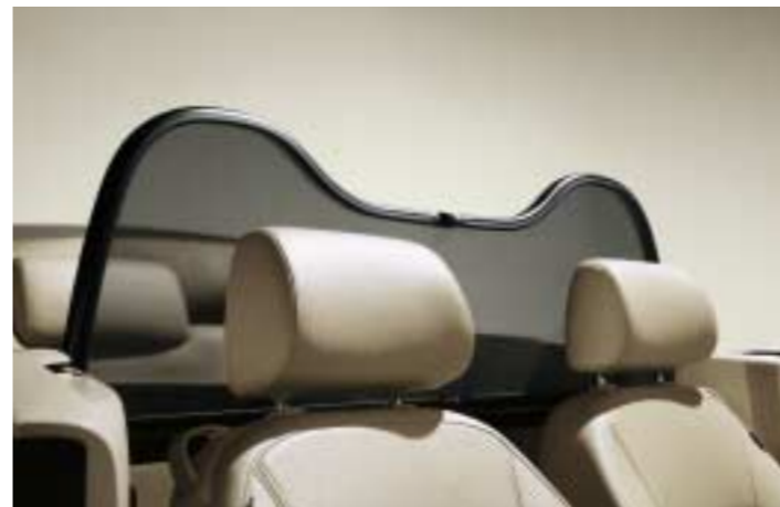
La pose du filet anti-remous est un jeu d'enfant. Il réduit le vent et les tourbillons d'air au niveau de la nuque (de série sur New Beetle Cabriolet).
