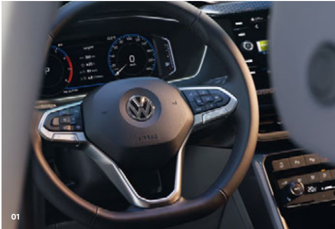
01 L’analogique appartient désormais au passé. Le Digital Cockpit Pro avec son écran haute résolution de 10,25 pouces affiche les combinés d’instruments sous un format numérique. Il peut vous fournir des informations allant bien au-delà de simples indications sur la vitesse et le niveau de carburant.
