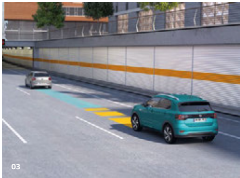
03 Le régulateur de vitesse adaptatif (ACC) vous aide à maintenir une vitesse maximale définie par vos soins, ainsi qu'une distance minimale par rapport au véhicule qui vous précède 1) .
