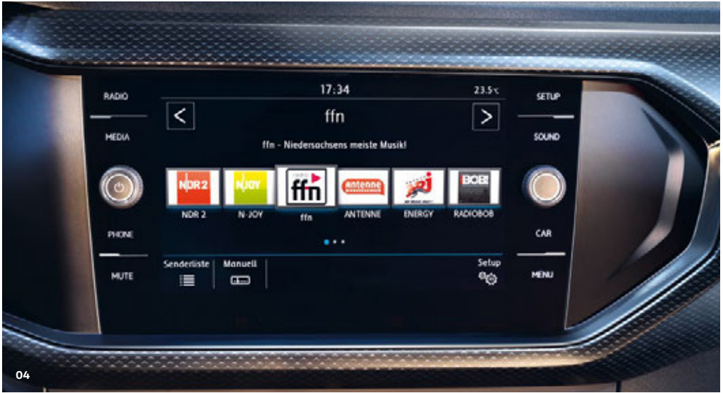
04 Le système de radio ‘ Ready 2 Discover ’ est doté de ‘Services de streaming et radio via Internet’ grâce à une carte eSIM intégrée. Cette radio comprend 6 haut-parleurs (4 x 20 W) avec un écran couleur tactile 8” haute résolution (800 x 480), des haut-parleurs avant/arrière, la lecture des formats audio MP3, un double tuner FM pour une réception radio de qualité optimale et l’affichage de la plage de lecture, du logo de la station à l’écoute.
