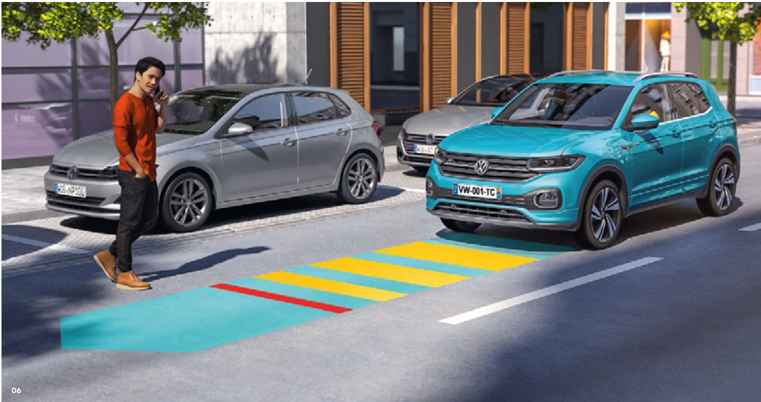
05 Le détecteur d'angle mort 'Blind Spot' vous avertit de la présence de véhicules dans l'angle mort grâce à des LED situées dans le rétroviseur concerné. 1) Lorsque vous sortez d'une place de stationnement en marche arrière, l'assistant intégré surveille la zone située derrière votre véhicule et vous signale toute circulation transversale détectée. 1)
