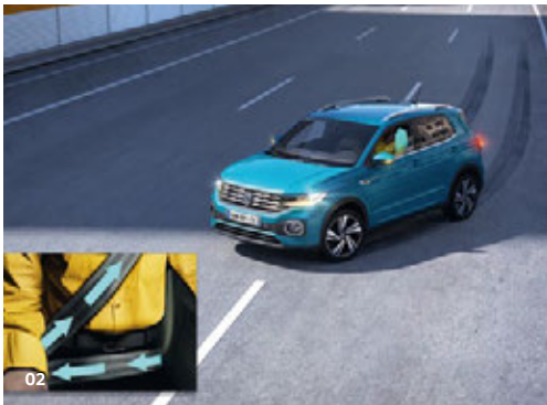
02 'Pre Safe Assist' : système proactif de protection des passagers : fonctionnant à partir de l'ESP, il permet d'optimiser la sécurité passive des passagers grâce au blocage des ceintures, à la fermeture des ouvrants. Après un premier choc, déclenchement automatique des feux de détresse. Cette fonction permet d'améliorer la sécurité avant et après l'impact.
