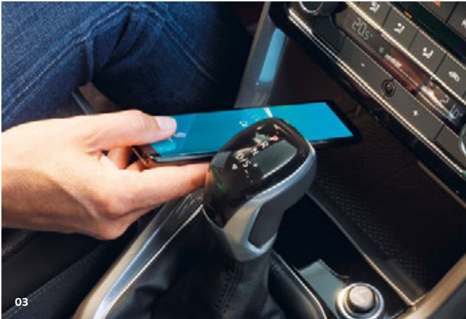
03 Magique ! Posez et rechargez votre téléphone sans avoir à le brancher grâce à la charge par induction , si celui-ci est équipé de la norme Qi.
