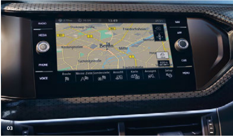
03 Le système de Navigation & Infotainment “Discover Media” est doté de ‘Services de streaming et radio via Internet’ grâce à une carte eSIM intégrée. La radionavigation comprend 6 haut-parleurs avant/arrière (4 x 20 W) et inclut un écran couleur tactile de 8” haute résolution (800 x 480). Ce système comprend également un double tuner FM pour une réception radio de qualité optimale, la possibilité de lire des formats audio MP3, deux ports USB-C compatibles Apple®, l’affichage cartographique en 2D ainsi qu’une interface Bluetooth® mains-libres pour téléphone portable avec fonction Audio Streaming A2DP permettant la lecture des musiques enregistrées sur le téléphone portable, via les haut-parleurs du véhicule. Avec ‘ We Connect ’ et ‘ We Connect Plus ’ d’une durée de 3 ans vous accédez à des services mobiles en ligne via votre Smartphone permettant à votre GPS d’intégrer les fonctionnalités suivantes : Informations routières en ligne, recherche de Point d’Intérêt (POI), personnalisation des Points d’intérêts, Météo.
