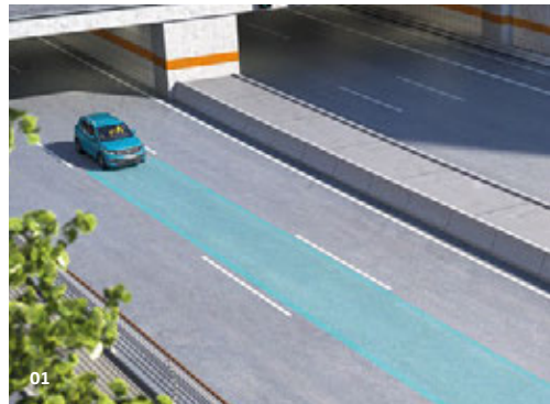
01 L'assistant de maintien de trajectoire 'Lane Assist' peut détecter, à partir de 60 km/h, si le véhicule quitte involontairement sa propre voie 1) et corrige la trajectoire par une action sur la direction 1)2) .
