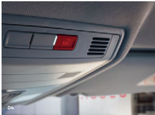
04 En cas d'urgence, vous bénéficiez de l'assistance du système d'appel d'urgence eCall . En cas d'accident, ce dispositif embarqué sur votre T-Cross se met manuellement ou automatiquement en relation avec les secours afin de leur transmettre des informations importantes, dans les limites du système.
