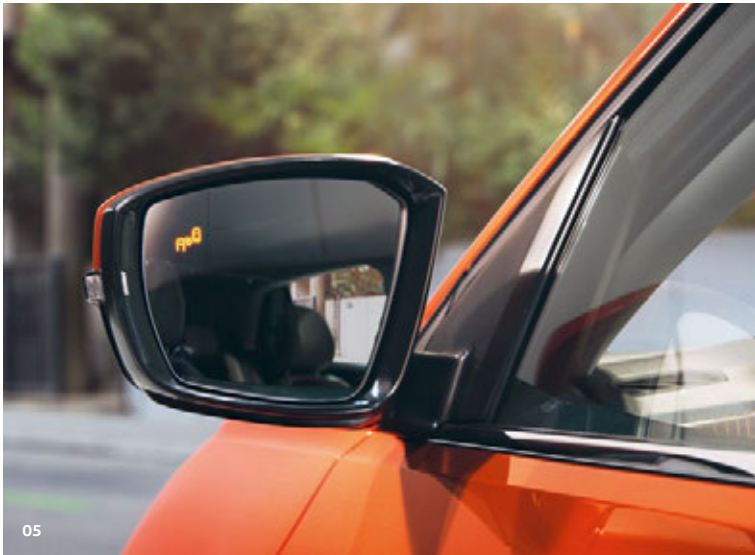
05 Le détecteur d'angle mort 'Blind Spot' vous avertit de la présence de véhicules dans l'angle mort grâce à des LED situées dans le rétroviseur concerné. 1) Lorsque vous sortez d'une place de stationnement en marche arrière, l'assistant intégré surveille la zone située derrière votre véhicule et vous signale toute circulation transversale détectée. 1)
