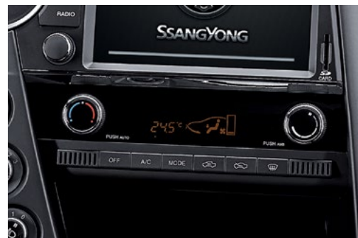
Αυτόματο σύστημα κλιματισμού
