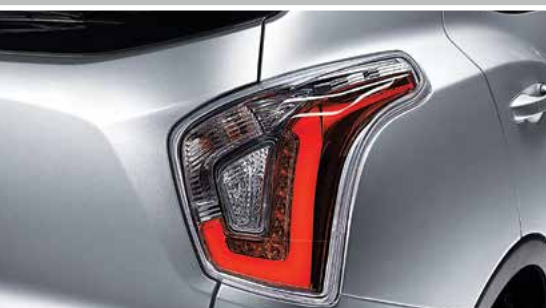
Πίσω φωτιστικά σώματα τεχνολογίας LED
