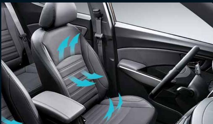
Αεριζόμενο κάθισμα οδηγού
