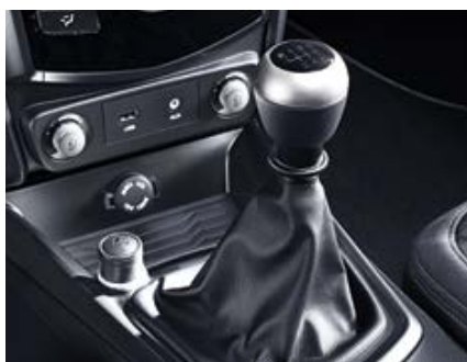
6-τάχυτο μηχανικό κιβώτιο (με δείκτη αλλαγής σχέσης)
