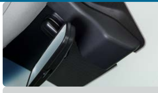
Σύστημα ανίχνευσης βροχής και μονάδα ελέγχου αυτ. φωτισμού
