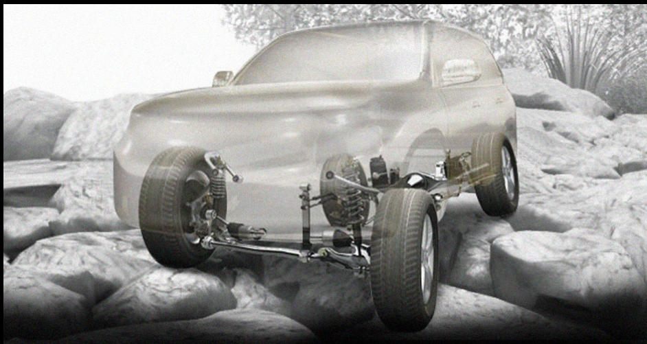
Tracción: Todas las versiones de Land Cruiser Prado vienen equipadas con tracción AWD (tiempo completo) controlada electrónicamente. Este sistema ofrece excelente conducción en caminos pavimentados y conducción suave pero robusta en lugares sin camino.
