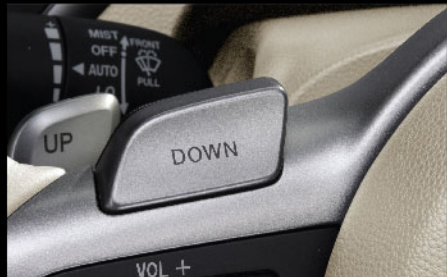
安設在軚盤上的轉檔撥片。 Automatic transmission paddle shifters mounted on the steering wheel.
