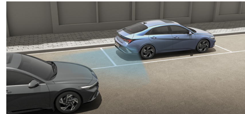
מערכת אקטיבית לציאה בטוחה מהרכב (SEA)* מערכת "ציאה בטוחה" המתריעה ומונעת פתיחת דלתות המושב האחורי במקרה של רכב חוצה.
