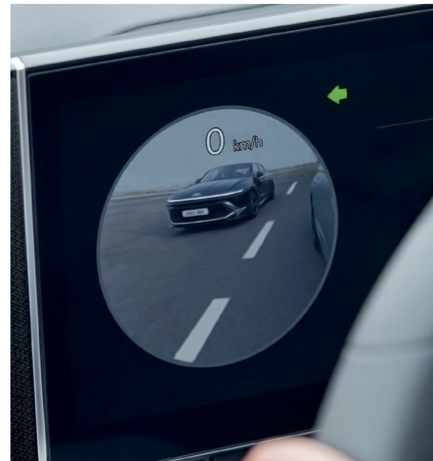
BVM - הצגת צילום חי של "שטח מת" על גבי לוח השעונים הדיגיטלי בעת הפעלת איתות*
