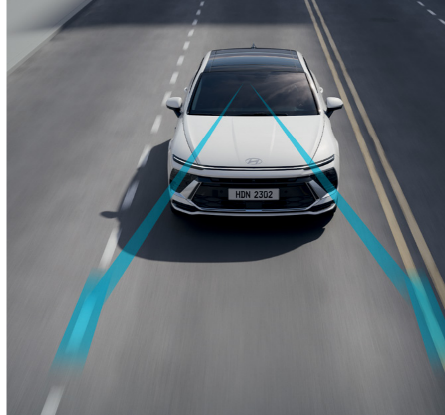
מערכת סיוע לשמירה על מרכז נתיב הנסיעה (LFA) מערכת אקטיבית המסייעת בשמירה על מרכז נתיב הנסיעה.
