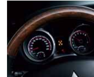
Instrumentos de alto contraste iluminados desde atrás con tacómetro, indicador de 4x4 e intensidad de la iluminación regulable 23
