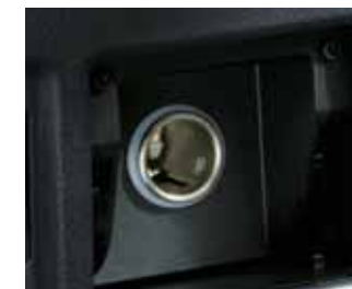
Tomacorriente auxiliar en el cuadro de instrumentos 32
