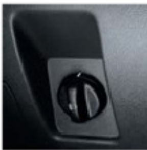
چراغ های جلو تنظیم زاویه چراغ نور چراغ های جلو از داخل خودرو.
