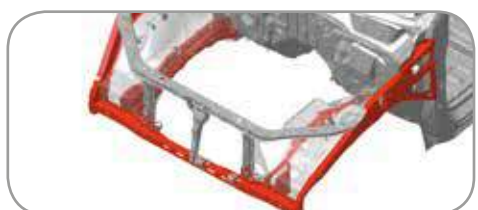
Compartimento del vano motore irrigidito
