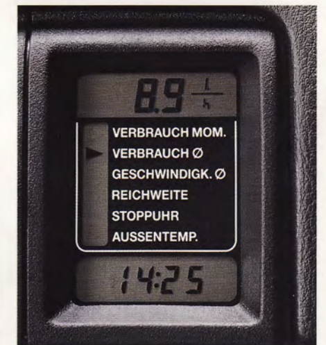
Il computer di bordo e il Check Control System informano in tempo reale su consumo di carburante, ora esatta, autonomia, temperatura esterna, velocità media e eventuali anomalie di funzionamento della vettura.
