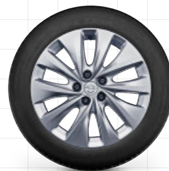
Cerchi in lega da 17'' con disegno a 10 razze in Bright Silver, 7,0 J x 17, pneumatici 205/55 R 17 3
