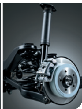
Sospensioni posteriori multilink Le sospensioni multilink disperdono l'energia dell'impatto e smorzano le vibrazioni, per un migliore comfort di guida
