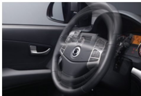
Servosterzo elettrico in funzione alla velocità Agisce in maniera più incisiva alle basse velocità e riduce l'effetto alle alte velocità, migliorando la stabilità a qualsiasi velocità
