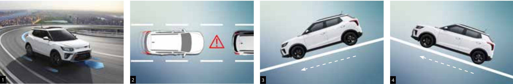
1 Protezione antibaltamento (ARP) 2 Segnale di arresto di emergenza (ESS) 3 Sistema di Controllo in Discesa (HDC) 4 Assistenza alla partenza in salita (HSA)
