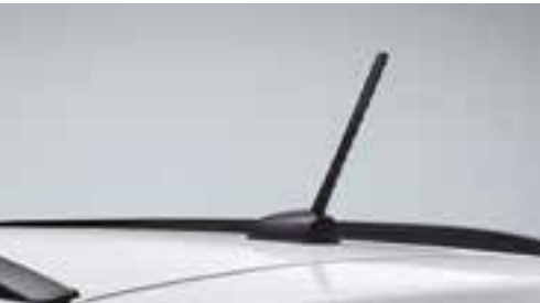
Antenna a asta montata sul tetto
