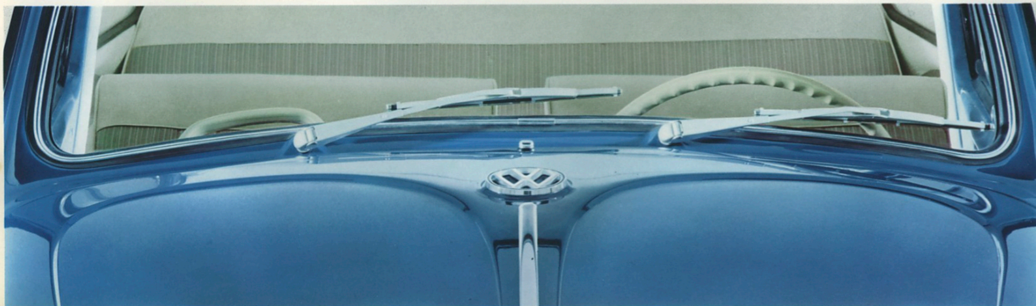
Posizione di riposo dei tergicristallo a sinistra; in caso di pioggia o neve, campo visivo più libero per chi guida.
