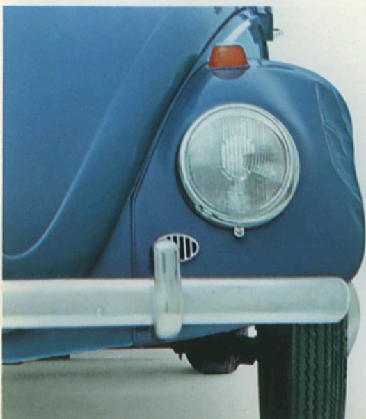
La sostituzione di un parafrango della VOLKSWAGEN 1200 è rapida ed economica: basta allentare 10 bulloni, e il pezzo viene fornito a buon mercato.
