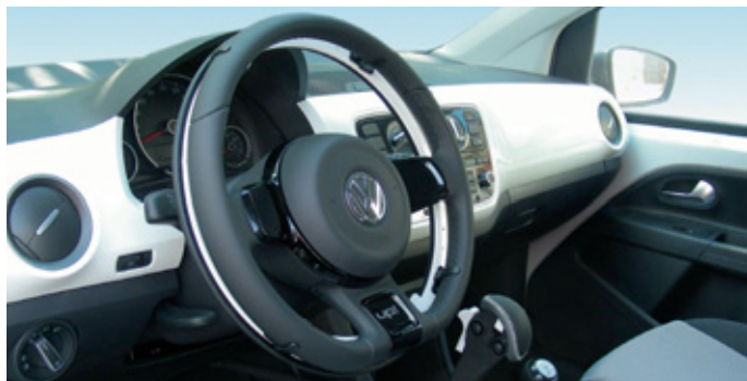
Acceleratore elettronico rotativo sotto il volante "Ghost" e freno di servizio a leva.
