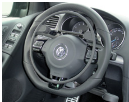
Acceleratore elettronico a cerchietto sopra il volante di tipo sfilabile e freno di servizio a leva.
